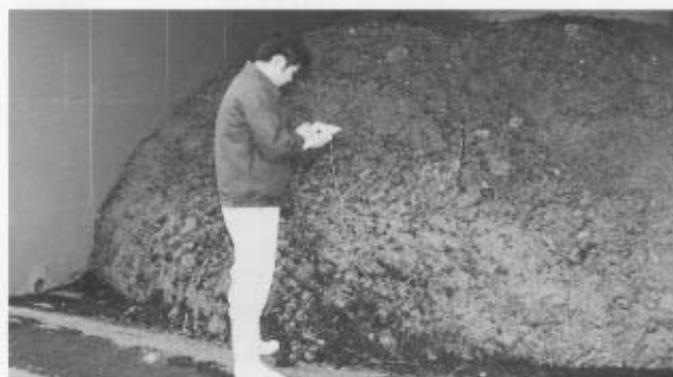
堆肥化中の発酵温度測定
